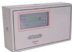
A **Central de Controle** deverá estar localizada em área de fácil acesso, monitorado 24 horas por dia, afastada de materiais inflamáveis ou tóxicos, ventilada e protegida contra penetração de fumaça. Estar a uma distância máxima à ser percorrida entre o local de instalação da central e uma área segura não pode ser superior a 25m.
