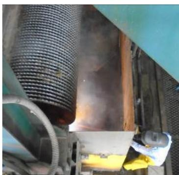
Os equipamentos envolvidos no processamento da cana-de-açúcar para extração do caldo sofrem elevado desgaste devido às condições severas de trabalho. Em função disso, necessitam da aplicação de soldagem de revestimento duro para o aumento da sua vida em serviço.
